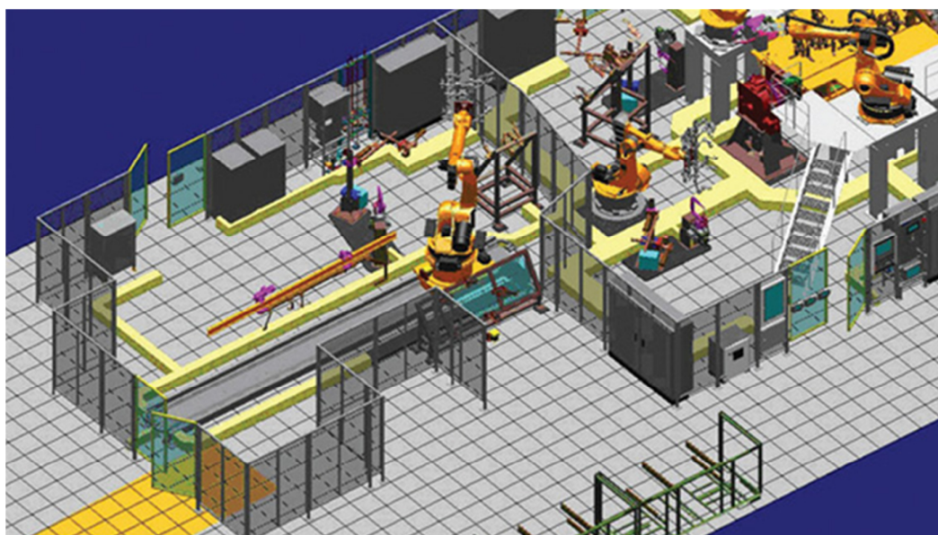
Figura 33 – Representação 3D de um layout no Siemens Tecnomatix. Fonte: BDEXPERT, 2011.
