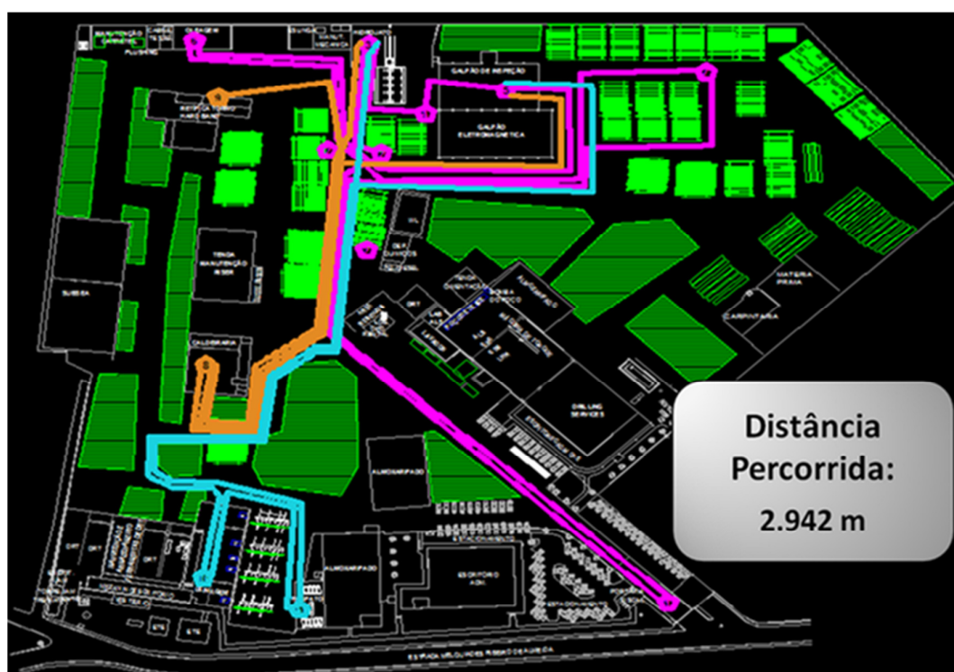
Figura 47 – Diagrama de fluxo de uma família de produtos feito no AutoCAD.
